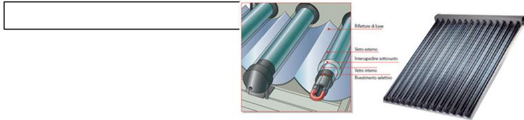
**Fig 2:** Principali componenti di un collettore sottovuoto
