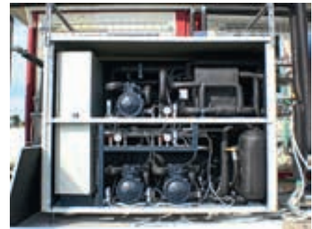
Figura 6 – Pompa di calore a CO 2 – Layout macchina
